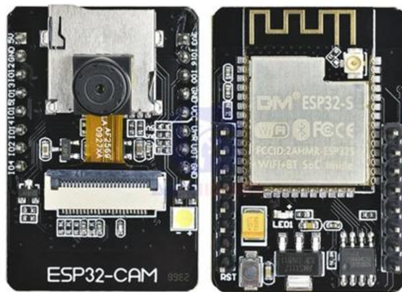
Рис. 2.7. Зовнішній вигляд модуля ESP32-CAM [20]
