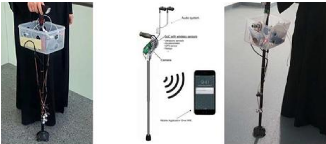
Рис. 1.20. Розроблений прототип носимого пристрою: розумна тростина
