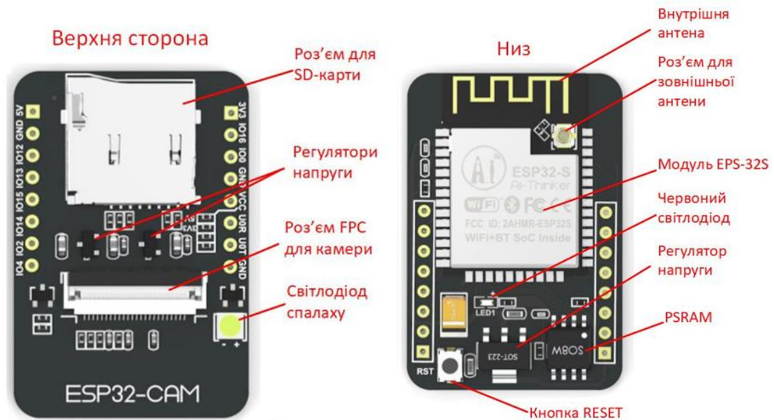
Рис. 2.8. Будова модуля ESP32-CAM
