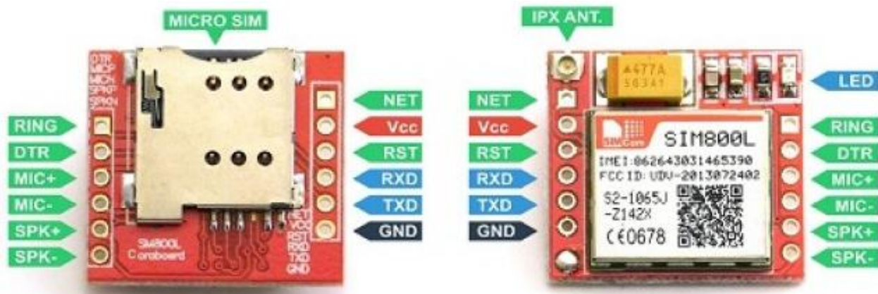
Рис. 2.20. Модуль GPS SIM800L з позначенням виходів Розпинування GSM-модуля SIM800L.
